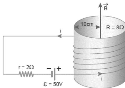
Considerando que a bobina da figura tem resistência  $R = 8 \Omega$ , possui 6 espiras, o raio mede 10 cm, e ela é alimentada por um gerador de resistência interna de  $2 \Omega$  e força eletromotriz de 50 V, a intensidade do vetor indução magnética no centro da bobina, no vácuo, vale:
